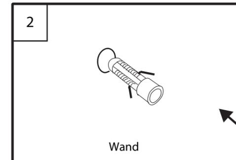
Bohren Sie 2 Löcher in die Wand. Setzen Sie 2 Kunststoffdübel in die Löcher ein.
