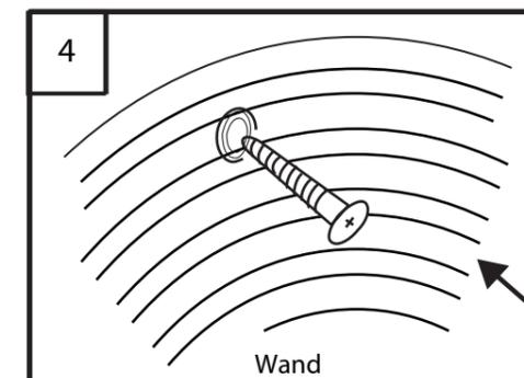
Befestigen Sie 2 Schrauben sicher in den Dübeln.
