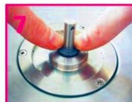
Legen Sie den luftdichten Ring entlang der Motor-Drehachse. Und reinigen Sie das restliche Schmieröl.
