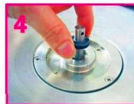
Luftdichtheitsring mit der Hand abnehmen
