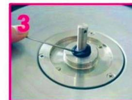
Bitte verwenden Sie einen dünnen Metallstab, um den luftdichten Ring herauszuheben (berühren Sie nicht die Motor-Drehachse)
