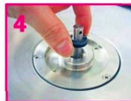
Luftdichtheitsring mit der Hand abnehmen
