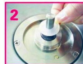
Nehmen Sie den Siliziumdioxid-Ring von der Motor-Drehachse ab.
