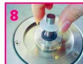
Setzen Sie den neuen Kieselgelring in die Maschine ein
