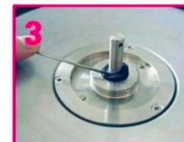
Bitte verwenden Sie einen dünnen Metallstab, um den luftdichten Ring herauszuheben (berühren Sie nicht die Motorumdrehungsachse)
