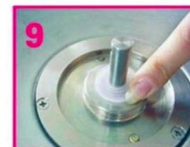
Befestigen Sie den Kieselgelring und den luftdichten Ring
