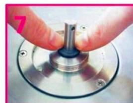
Bringen Sie den Dichtungsring entlang der Motordrehachse an. Und reinigen Sie das restliche Schmieröl.
