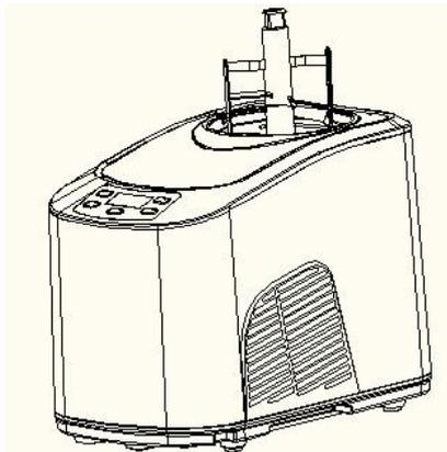
4/ Setzen Sie die transparente Abdeckung wieder auf und drehen Sie sie im Uhrzeigersinn, um sie fest zu installieren. Stecken Sie dann das Gerät ein
