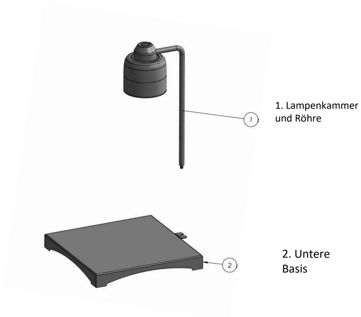
Verbinden Sie das Rohr (Nr. 1) mit der Grundplatte (Nr. 2), indem Sie das Band mit dem Schraubenschlüssel festziehen.
