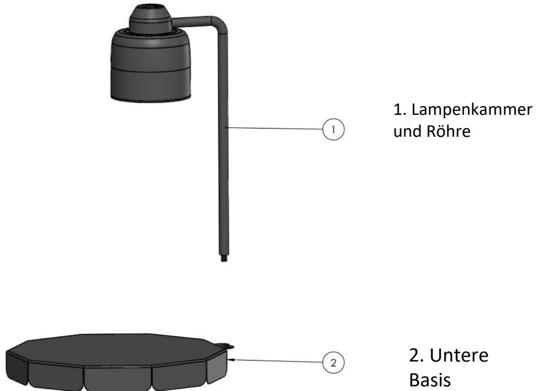
Verbinden Sie das Rohr (Nr. 1) mit der Grundplatte (Nr. 2), indem Sie das Band mit dem Schraubenschlüssel festziehen.
