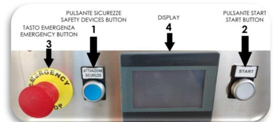
**Hinweis:** Beim ersten Schneidezyklus muss die Starttaste Nr. 2 zweimal gedrückt werden, um die Maschine zu sichern, andernfalls beginnt die Maschine nicht zu schneiden. Das weiße Licht blinkt, wenn dieser Schritt erforderlich ist.
