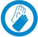
Der Bediener muss hitzebeständige Handschuhe tragen, wenn er die Bleche aus dem Ofen nimmt und sie anfasst. Der Bediener sollte keine lose Kleidung oder Krawatten tragen. Außerdem ist das Tragen eines Haarschutzes (Haube) vorgeschrieben.
