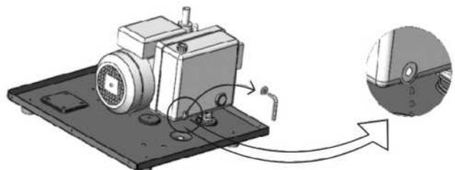
(1) Entfernen Sie die Schrauben.
