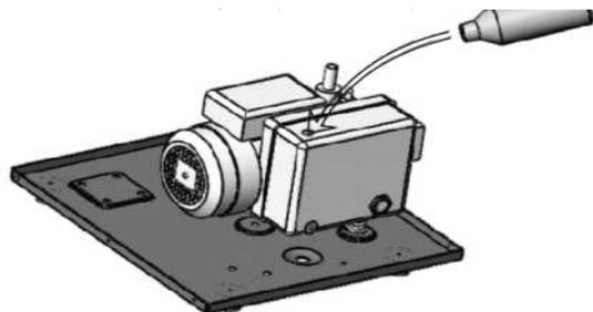
(5) Der Ölfüllstand sollte zwischen der Mitte und 3/4 des Sichtfensters liegen.
