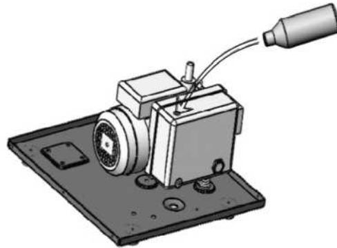
(5) Der Ölfüllstand sollte auf Höhe zwischen der Mitte und 3/4 des Sichtfensters liegen.
