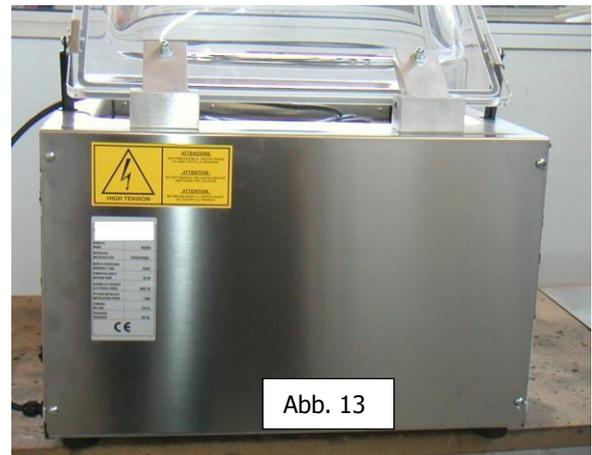
1. Für den Zugang zum Maschineninnenraum das Schutzgehäuse (1, Abb. 13) entfernen, nachdem die 4 Befestigungsschrauben (6) gelöst wurden.
