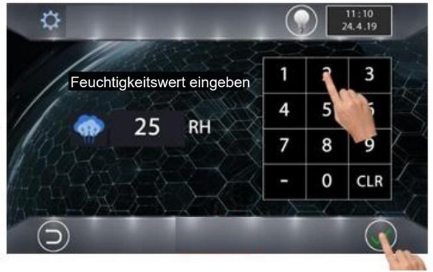
**Einstellung der relativen Luftfeuchtigkeit im Bereich der Backverzögerung**
