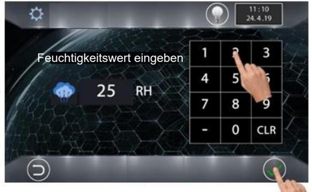
**Einstellung der relativen Luftfeuchtigkeit auf der Prüffläche**
