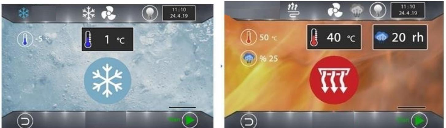
Seite für die Einstellung von Temperatursollwert, Luftfeuchtigkeit und Ventilatorgeschwindigkeit. Die Anzeige der Feuchteinstellung unterliegt der Feuchteregelung im gewünschten Zyklus.
