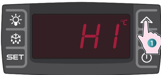
1 Durch kurzes Drücken der Taste
