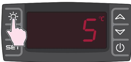
Wenn die Einheiten über Leuchten innerhalb der Fächer verfügen, für deren Einschalten die Taste
