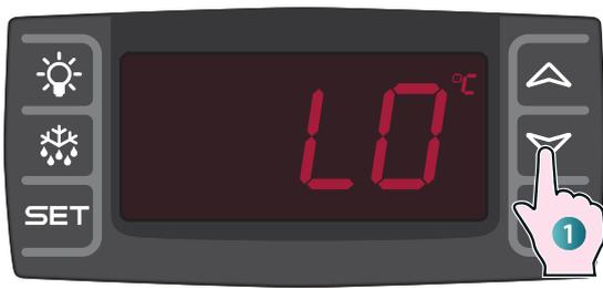
1 Durch kurzes Drücken der Taste
