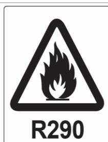
**PRECAUCIÓN: RIESGO DE INCENDIO O EXPLOSIÓN. REFRIGERANTE INFLAMABLE. ÚNICAMENTE DEBE SER REPARADO POR UN TÉCNICO CUALIFICADO. NO PERFORAR LA TUBERÍA DEL REFRIGERANTE.**
