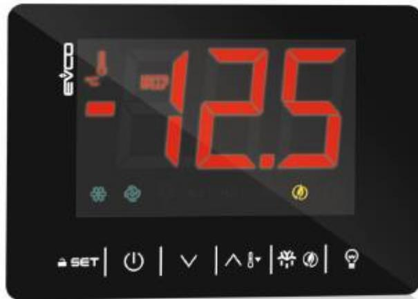
**Wichtige Warnung:** Wenn innerhalb von 30 Sekunden keine Maßnahmen bezüglich des Digitalthermometers ergriffen werden, sperrt sich das Digitalthermometer selbst. Beim ersten Drücken erscheint das Wort „Loc“ auf dem Bildschirm. Um es zu öffnen, halten Sie eine beliebige Taste 2 Sekunden lang gedrückt. Daraufhin erscheint das Wort „UnL“ und es ist möglich, das Digitalthermometer zu bedienen.
