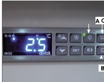
Drücken Sie den ON/OFF-Startschalter (B). Der Schalter leuchtet auf und Sie hören, wie der Motor nach einer Verzögerung von 1 Minute anläuft.
