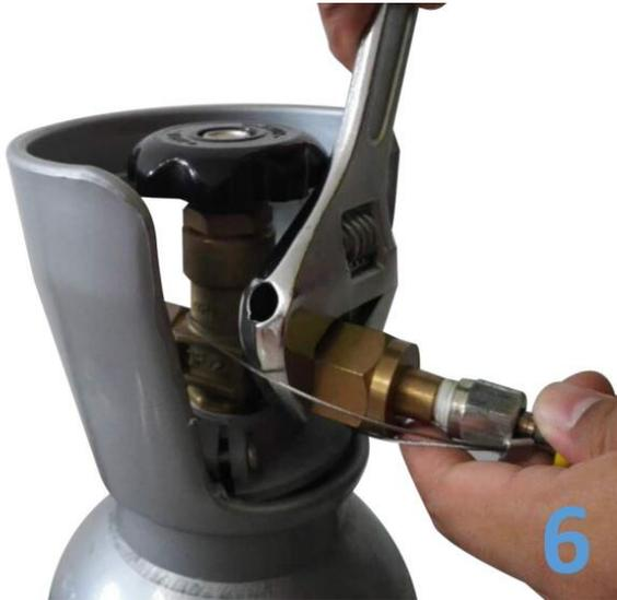
Verwenden Sie den Schraubenschlüssel, um Mutter und Ventil zu verstärken
