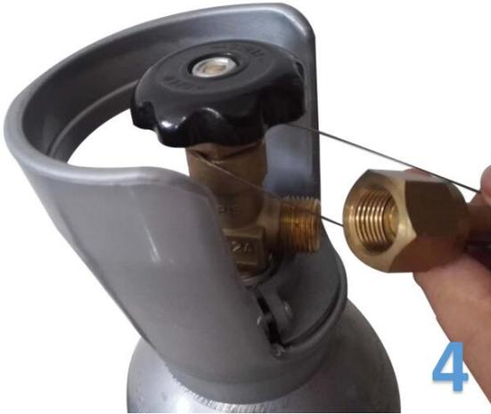
Der Stahldraht verdeckt das Ventil aus Sicherheitsgründen
