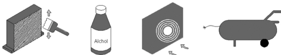
Figure 6 Nettoyage du condenseur
