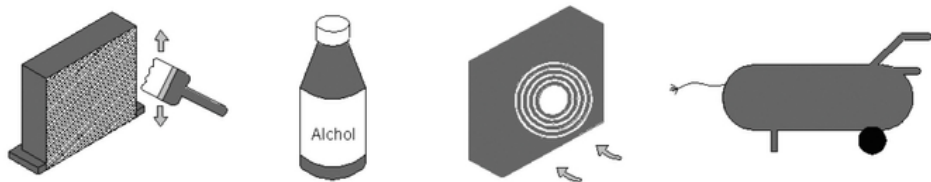
Bild 6 Reinigung des Kondensators
