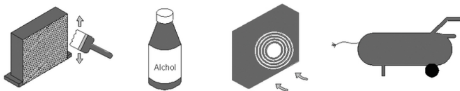
Figura 6 La limpieza del condensador
