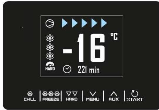
Wenn der Nadelfühler die richtige Temperatur erreicht hat oder die Zeitspanne abgelaufen ist, ertönt nach Beendigung des Schockkühl-/Schockgefrierzyklus der Summer und die Konservierungsphase beginnt. Wird der temperaturgesteuerte Zyklus nicht in der vorgesehenen Zeit abgeschlossen, wird das Problem durch eine Alarmmeldung angezeigt.
