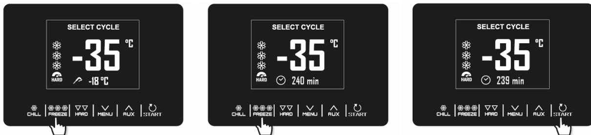
Beispiel für einen temperaturgesteuerten Schockgefrierzyklus (Nadel), Umstellung auf einen zeitgesteuerten Zyklus, schnelle Änderung der Dauer des Schockgefrierzyklus und des Startzyklus.
