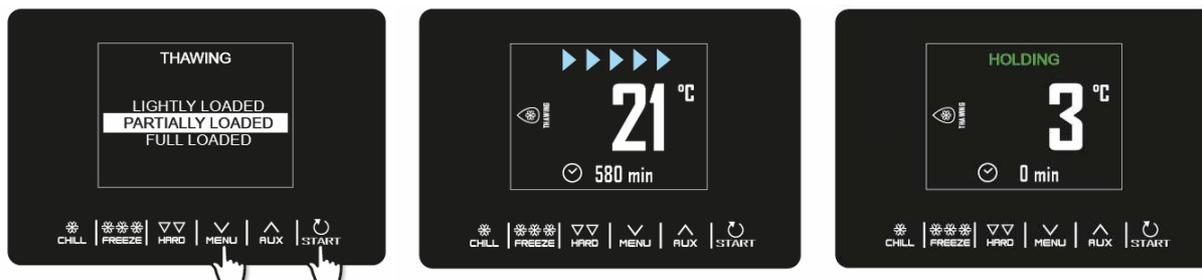
Die Steuerung des Abtauzyklus erfolgt in Abhängigkeit von der Menge des aufzutauenden Produkts, das in das Gerät geladen wird, im Verhältnis zu der vom Hersteller angegebenen Höchstmenge. Der Einfachheit halber werden die wählbaren Beladungsmengen in drei Bereiche unterteilt, für die der Regler jeweils drei verschiedene Sätze vordefinierter Parameter nach folgendem Schema lädt:
