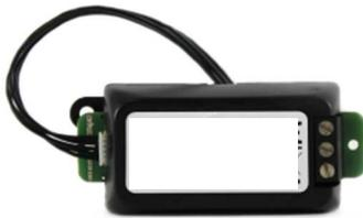
Über den TTL-Kommunikationsanschluss bietet er dem Steuergerät Bluetooth-Konnektivität, die eine drahtlose Verwaltung über Smartphones und Tablets mit der App ermöglicht.
