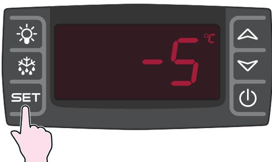
Um die als "default" eingestellte Temperatur (-5°C für statische Kühlflächen und -becken, +5°C für Flächen und Vitrinen mit Ventilation) anzuzeigen, die Taste **SET** kurz drücken.
