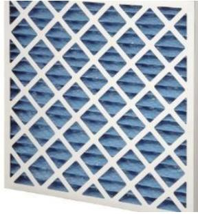
**Aufbau Plattenfilter sind plissierte Filter, die in einem feuchtigkeitsbeständigen Kartonrahmen montiert sind. Das synthetische Filtermedium ist progressiv aufgebaut, was eine hohe Staubabscheideleistung garantiert. Diese Technik garantiert einen geringeren Luftwiderstand, was zu einem niedrigeren Energieverbrauch führt.**
