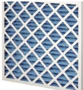
Die Cdestruction Panel Filter sind plissierte Filter, die in einem feuchtigkeitsbeständigen Kartonrahmen montiert sind. Das synthetische Filtermedium ist progressiv aufgebaut, was eine hohe Staubabscheideleistung garantiert. Diese Technik garantiert einen geringeren Luftwiderstand, was zu einem niedrigeren Energieverbrauch führt.
