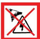
Hochdruckstrahl nicht auf spannungsführende Leitungen, elektrische oder elektronische Geräte oder den Hochdruckreiniger selbst richten
