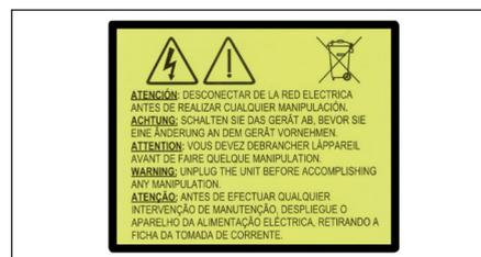
Diese Kennzeichnung beim Verbindungskabel zeigt Gefahren in Verbindung mit Stromverbindungen des Geräts an.
