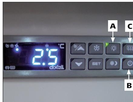
Den Inbetriebnahmeschalter (ON/OFF, B) einschalten. Dieser Schalter leuchtet auf und man hört den Motorstart mit 1 Minute Verzögerung.
