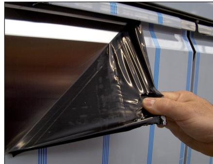
Nach Lieferung: Kunststoffschutzteile entfernen. Die Reinigung des gesamten Geräts erfolgt mit einem Schwamm bzw. Putzlappen, lauwarmem Wasser und milder Seifenlauge. Die Verwendung von Scheuermitteln, Lösungsmitteln, unverdünnten Metallreinigern bzw. Detergentien ist untersagt. Anschließend das gesamte Gerät, insbesondere rostfreie Stahlteile, mit einem sauberen Tuch trocknen.
