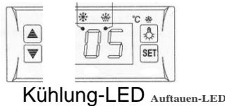
Die kleine integrierte Anzeige mit intelligenter Steuerung für die Nutzung des Kompressors.
