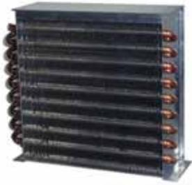
Die Reinigung des Gaskondensators muss bei ausgestecktem Gerät und Entfernung der Schutzvorrichtungen (Gitter) oder durch Herausnehmen des Kondensators (je nach Modell) erfolgen. Um den zwischen den Lamellen des Verflüssigers abgelagerten Schmutz zu entfernen, wird eines der folgenden Verfahren empfohlen:
