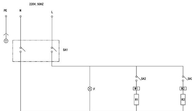
SA1-Beleuchtungsanzeige SA2-Schalter für Popcornheizung und Motor
