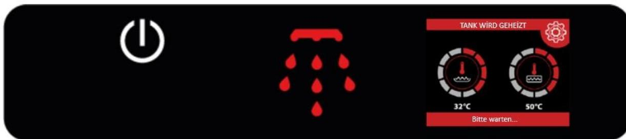
Die Maschine heizt zuerst den Behälter und dann das Wasser auf. Damit sich das Wasser während dieses Vorgangs schneller erwärmt, muss die Maschinentür geschlossen sein. Der Waschvorgang beginnt erst, wenn der Waschtank die werkseitig eingestellte Temperatur erreicht hat. Wenn die Maschine aufgewärmt ist, erscheint das Hauptmenü und das Menü wird angezeigt.
